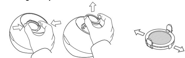
1. Ôter le disque métallique et sortir le support du pad en feutre. Pour cela, ramener doucement les deux languettes vers le milieu à l'aide du pouce et de l'index.
