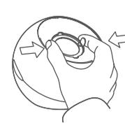
3. Replacer le support du pad en feutre dans l'appareil. Respecter le positionnement exact et laisser les languettes à gauche et à droite s'enclencher.
